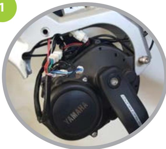
Se necessario, liberare il motore da eventuali protezioni di plastica. Successivamente rimuovere i bulloni superiori e allentare il terzo. Quindi, abbassare con delicatezza il motore manualmente.
